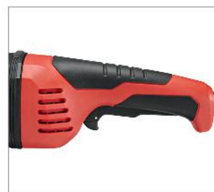
Ξεκούραση αποδοτική εργασία Ένας δοκτύλιος απόσβεσης κραδασμών μεταξύ του κινητήρα και της πίσω λαβής μειώνει σημαντικά τους κραδασμούς
